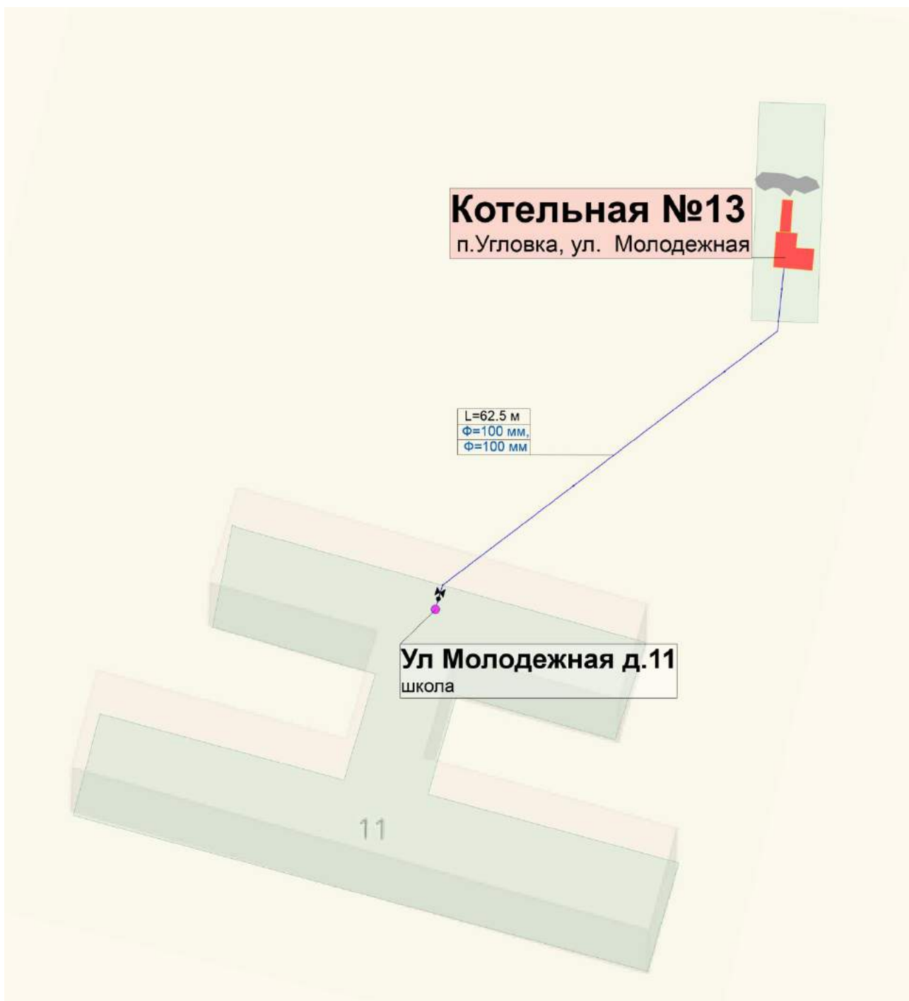
Рисунок 1.2 Схема тепловых сетей котельной №13, п. Угловка, ул. Молодежная
