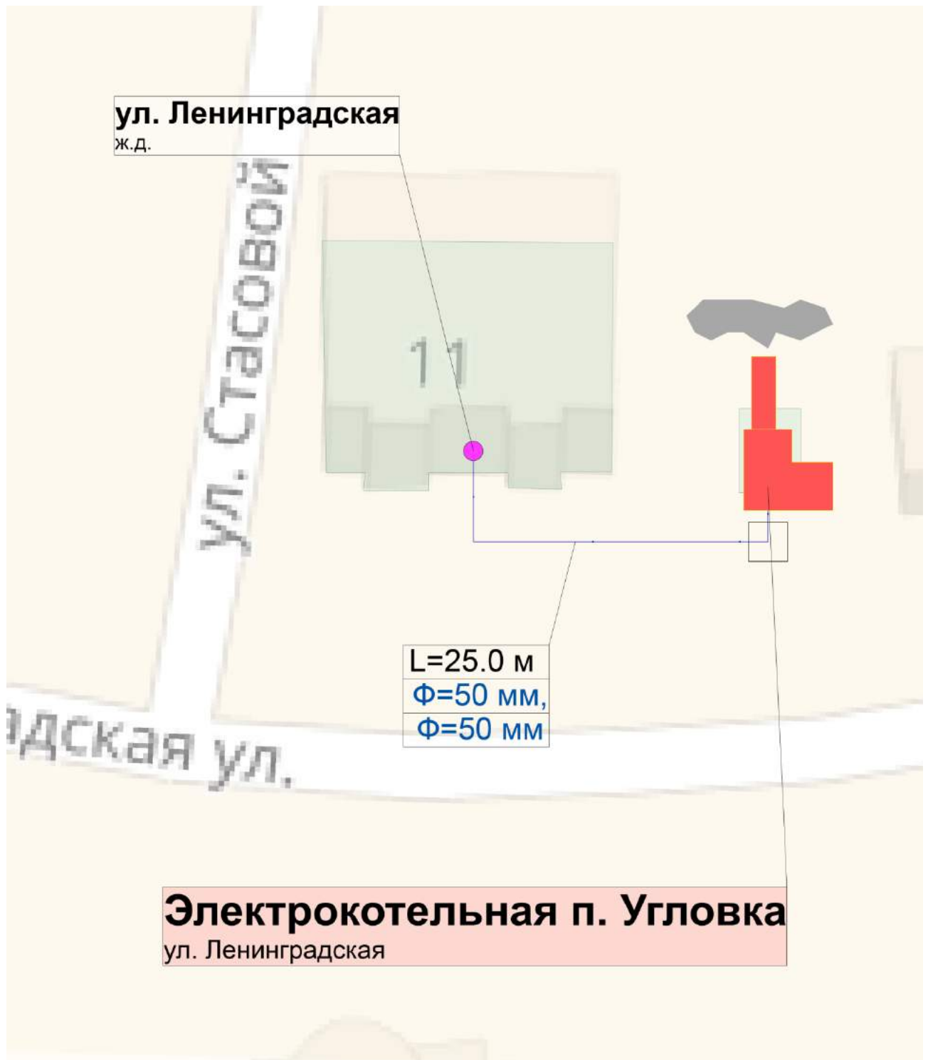
Рисунок 1.3 Схема тепловых сетей электрокотельную пос. Угловка, ул. Ленинградская
